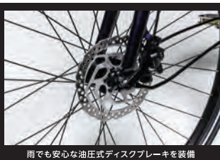
雨でも安心な油圧式ディスクブレーキを装備
